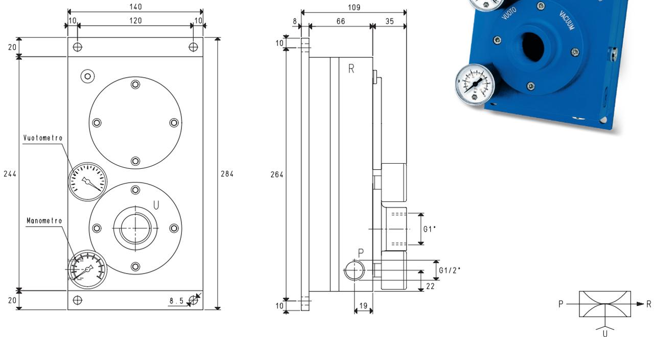
P=CONNESSIONE ARIA COMPRESSA      R=SCARICO      U=CONNESSIONE VUOTO
